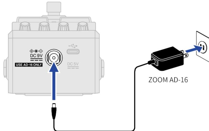
При подключении адаптера переменного тока MS-60B+ автоматически включается.
