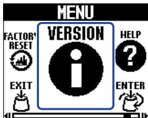
2. Проверьте версию на экране VERSION. Здесь отображаются прошивка и предустановленные версии.
