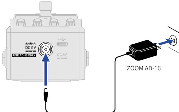
При подключении адаптера переменного тока MS-200D+ автоматически включается.
