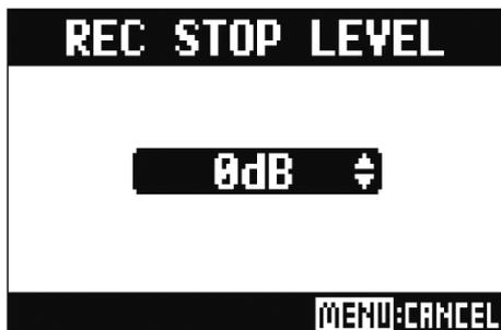
Запись остановится автоматически, если уровень сигнала на мастер-шине будет ниже порогового значения в течение периода, установленного в шаге 2.
